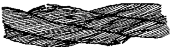
Рис. 1. Обрывы и смещения проволок каната крестовой свивки
